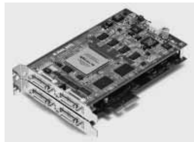
写真1 画像入力ボード「APX-3318」の上に画像処理ボード「PSM-3318-02」を接続した外観
