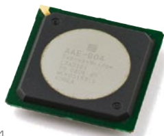
PCI Expressボード製品の核となる 独自に開発したブリッジLSI:AAE-B04
